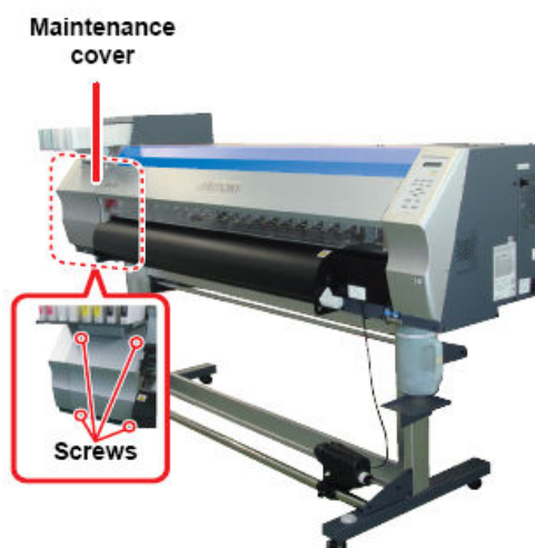
Tampa da Manutenção
